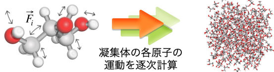
図2. 分子動力学法による原子運動の計算
