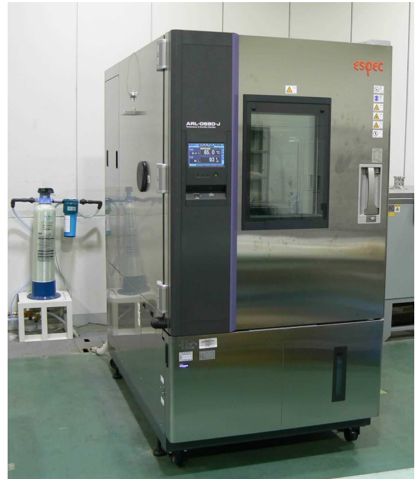
図1 高温型恒温恒湿槽の外観
