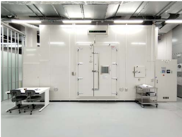
IAQセンターの中核装置 「空気質評価用大型チャンバー」(30m 3 ) 横幅:約7m、高さ:約3.6m
