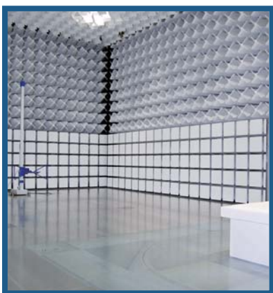
第一電波暗室（10m法）
