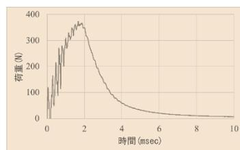
[測定例] 衝撃荷重の時間変化
