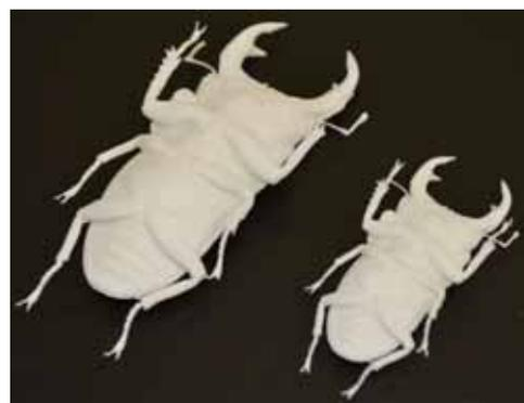
(b) X 線 CT データからの形状データを用いたクワガタムシの拡大モデル
