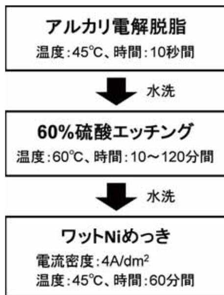
図5 めっき試料作製工程
