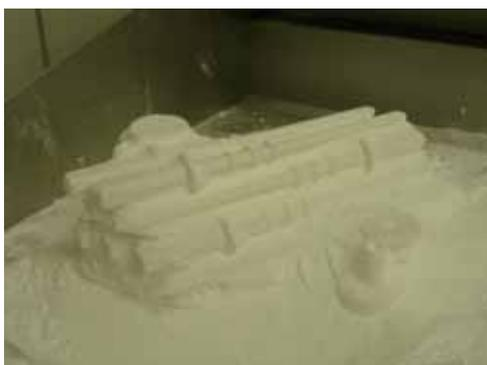
図 6 SLS 造形における造形物掘り出し（アンパッキング）作業
