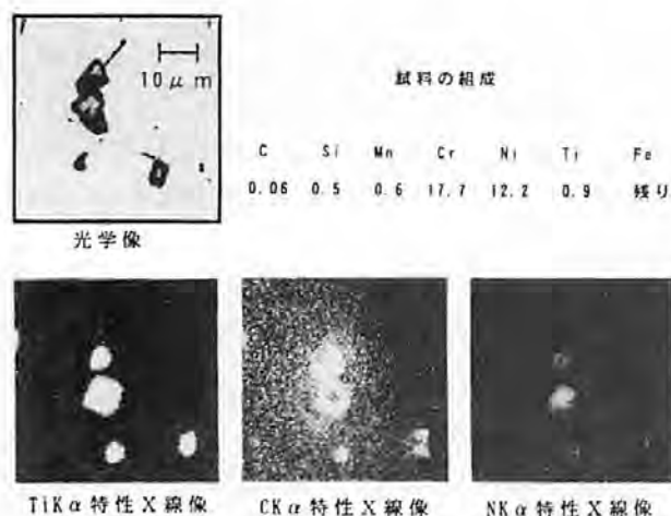
図13 18-8ステンレスの析出物の光学像およびTi, C, Nの特性X線像 35)
