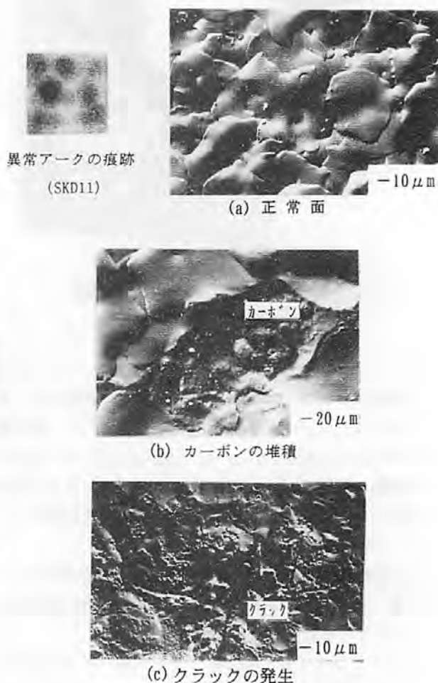
図6 異常アークの発生箇所とその拡大
