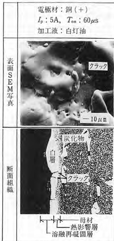
図1 形彫り放電加工面のミクロ写真（SKD11）
