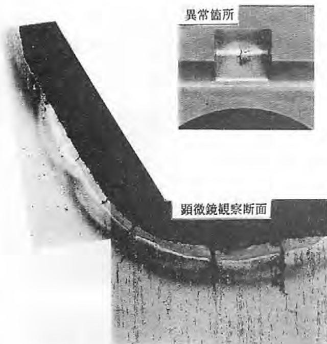
図7 腕時計用鍛造金型での異常アーク痕 (SKD11)
