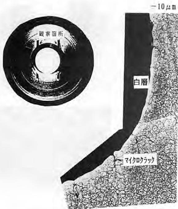
図2 型割れ箇所の拡大写真と断面組織 (腕時計用鍛造金型 SKD11)
