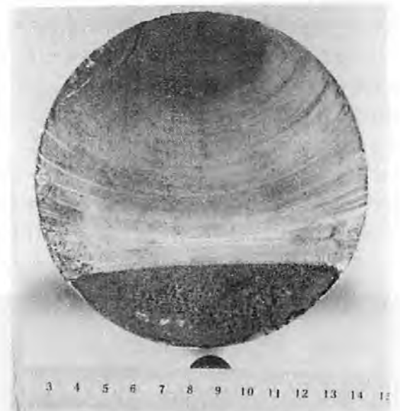
図13 ビーチマーク、調質されたマルテンサイト系ステンレス鋼のピストンロッド
