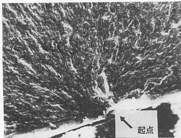
図15 放射状模様、SUP材コイルパネの疲労破壊
