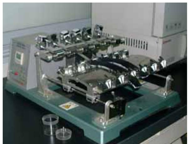
図3 学振型摩擦堅ろう度試験器
