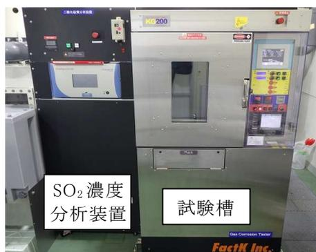
図 1. 二酸化硫黄ガス腐食試験機
