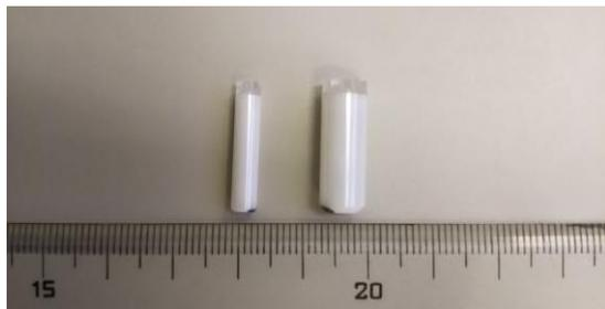
図 1 固体 NMR 測定用試料管 (左; 4 mm 用、右; 7 mm 用)
