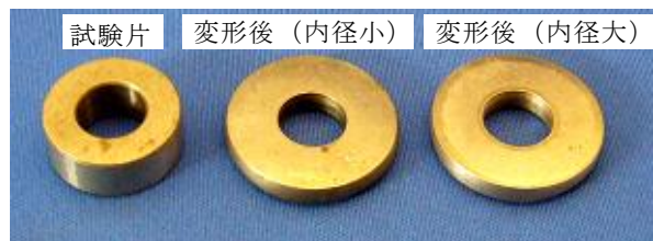
図4 リング圧縮試験 (変形後の試験片の内径が大きい方が摩擦係数は低い)
