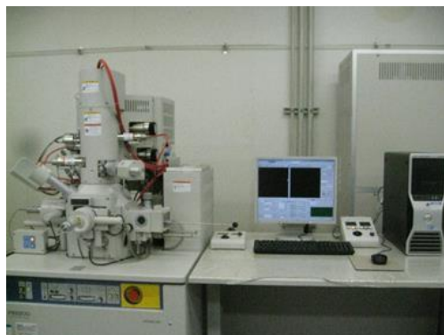
図1 集束イオンビーム加工観察装置の外観
