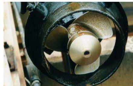
図 1 腐食、摩耗環境下に適用した例
