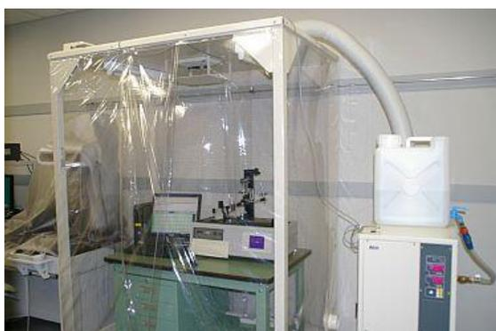
図 4 恒温恒湿度制御装置
