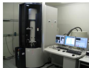
球面収差機能付走査透過電子顕微鏡 (日立 HD-2700)
