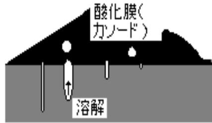
ここで問題にしたい孔食は、表面に緻密な薄い酸化膜（不働態）ができて通常は腐食が起らなくなっているとされている金属に生じる孔食である。鉄族金属、クロム、アルミニウムやチタンなどの軽金属などがこれにあたる。普通の鋼の不働態は比較的容易に酸素を放出して活性態になりやすいので孔食になることは少ない。よく見られるものはステンレス鋼に起きる孔食であるからこれを例にとって説明する。
